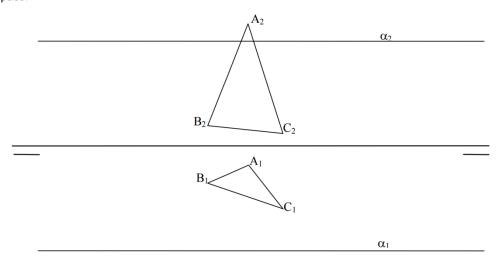
**B2.-** Sean **AB** y **BC** dos de los lados de un hexágono regular. Conocida la proyección diédrica vertical  $B_2C_2$  y ambas proyecciones para el lado **AB**, completar las proyecciones del hexágono.
