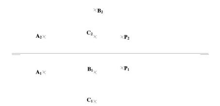
**B3.-** El plano  $\alpha$  produce una intersección en la chapa triangular **ABC** definida en la figura. Hallar las proyecciones de dicha sección, y definir las partes vistas y ocultas de la chapa, suponiendo que el plano  $\alpha$  es opaco.
