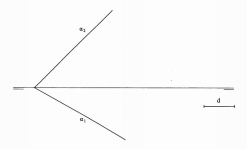
A2.- Dibujar una pirámide recta de base hexagonal regular apoyada en el plano horizontal de proyección sabiendo que una de las aristas de dicha base es el segmento  ${\bf r}$ , y que sus caras laterales forman un ángulo de  ${\bf 60^o}$  con el plano horizontal. La pirámide se encuentra integramente en el primer cuadrante. Trazar la sección producida, en la pirámide, por el plano  ${\bf \alpha}$ .
